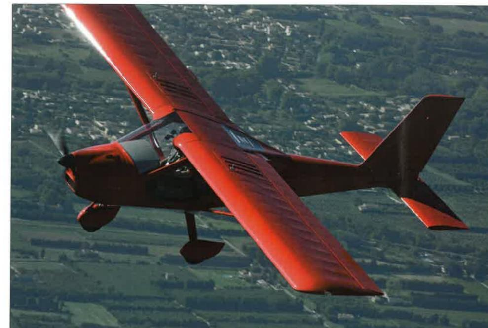
recalculé afin d'améliorer l'aérodynamisme et le rendre plus rapide. Son profil d'aile est différent, cette dernière est plus courte, le fuselage est un peu plus long et moins haut, la commande de profondeur est monobloc, des karmans fixés aux liaisons des haubans et à l'emplature des ailes ont supprimé les traînées parasites.
